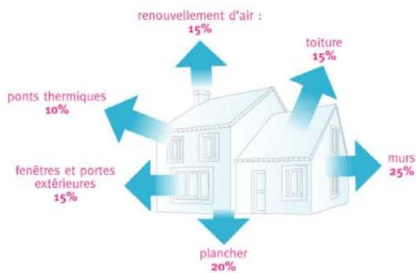
Les isolants thermiques sont 50 fois plus isolants que les matériaux de construction classique. Autrement dit, un panneau isolant de 10 centimètres a la même efficacité qu'un mur en pierre de 5 mètres d'épaisseur
